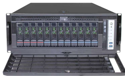
N4 モデルラックマウント仕様 (青:SAS/SATA 赤:NVMe, ODD オプション)
