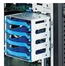
ローデット方式ツールレスベイ
