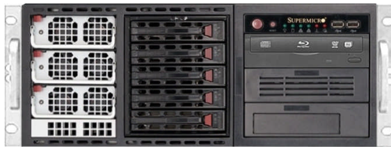
フロント(2+1リダンダント電源仕様)
