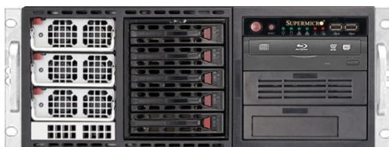
フロント(2+1リダンダント電源仕様)
