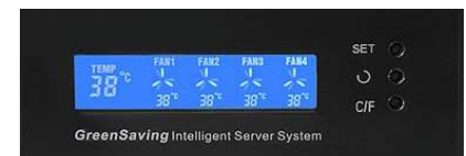
省エネコントローラ表示部
