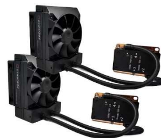
水冷ユニット (12cm x 38mm ファン) 2 ユニット使用
